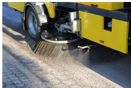
Sistema de inyección de agua para control de polvo
