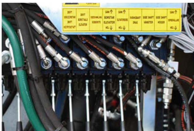
Bloque hidráulico y todos los componentes de fácil acceso
