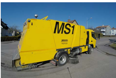
Tanque de residuos de 4m 3
