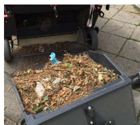
Tanque de residuos con recogida en saco
