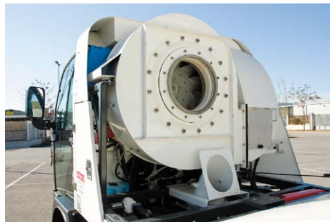
Turbina de aspiración
