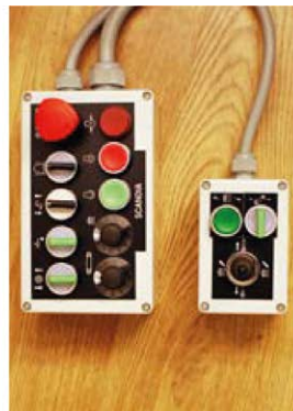
Panel de control en la cabina del camión
