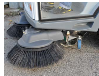
Zona de aspiración con aspersores de agua
