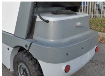
Tanque de agua 400 Lts
