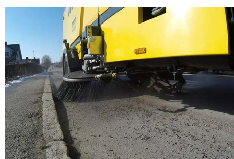
Sistema de presión automática de los cepillos
