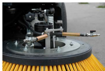
Aspersores de agua
